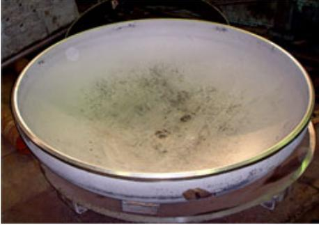
Применяются для сосудов, аппаратов и котлов, работающих под давлением до 6,3 МПа в условиях различных температур.
