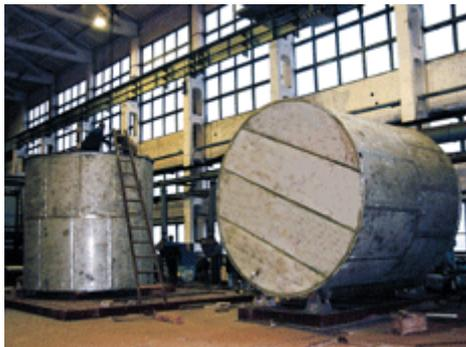
Завод "Вента" изготавливает чаны контактные, баки, отстойники, ресиверы, влагоотделители и другое емкостное оборудование для предприятий атомной отрасли.
